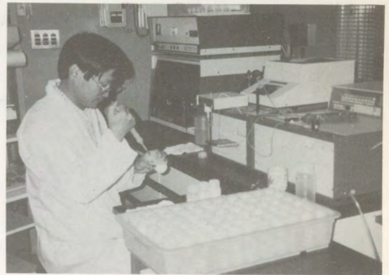
光化学式分析装置による 乳成分及び体細胞数の測定
