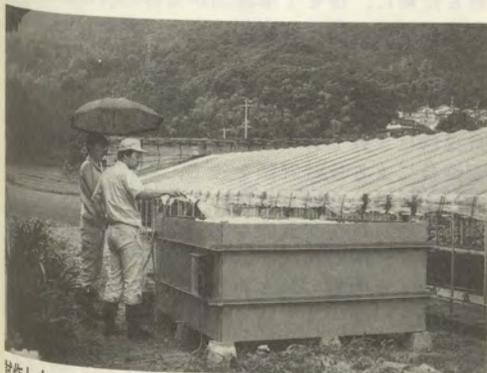
試作したロックウール脱臭装置
