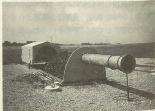
写真4 堆肥化過程からの環境負荷ガスを測定するためのチャンパー（4 m×2 m×2 mで約1トンの堆積物について評価できる）
