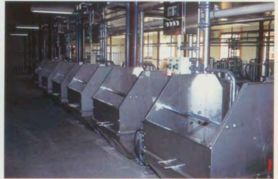
フリーストール牛舎精密試験棟：自動計量飼槽
