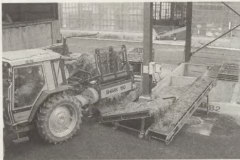
写真2 地下角形サイロへの再貯蔵作業
