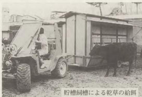
図4 開発した移動式給餌車
