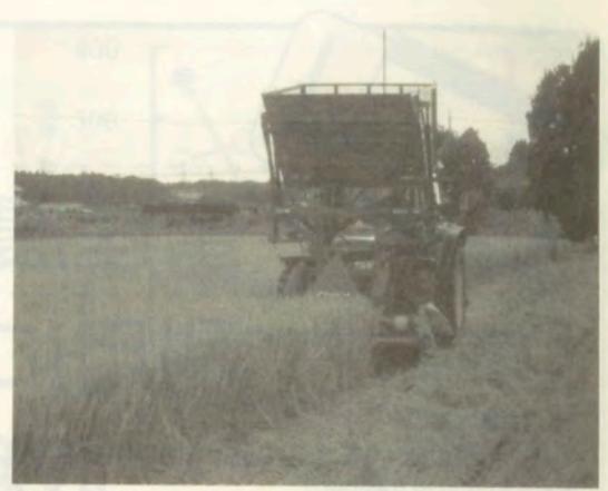
図2 前装モアコンディショナ(刈幅2.4m)による刈り取り作業(作業速度:1.2m/s)
