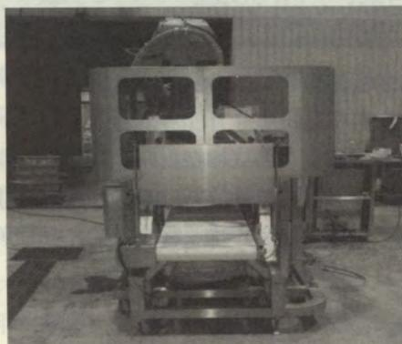
写真1 豚ロース・バラ脱骨システム
