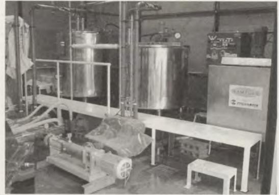
写真1 発酵リキッド飼料調製用施設
