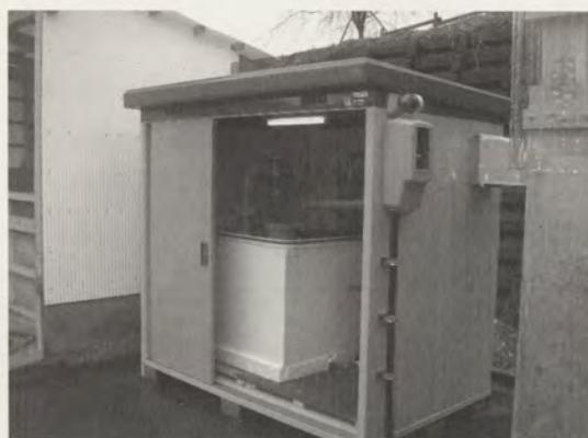
写真1 市販の物置に収納したスクラバーの一式（富山県畜産試験場）
