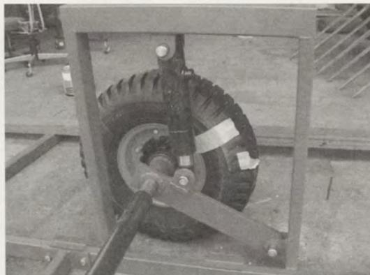
写真3 トラクターの油圧を利用したタイヤ昇降装置
