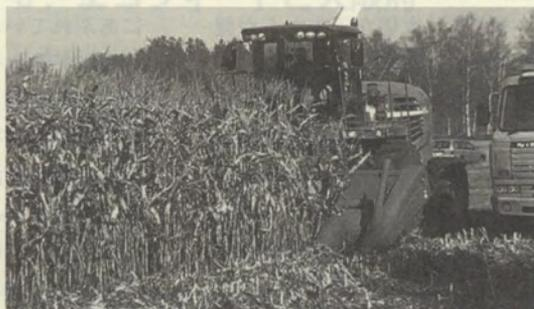
写真1 スナップヘッド装着自走式ハーベスタによるイアコーン収穫風景
