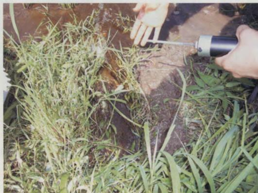
アンモニア検知管による水口臭気調査
